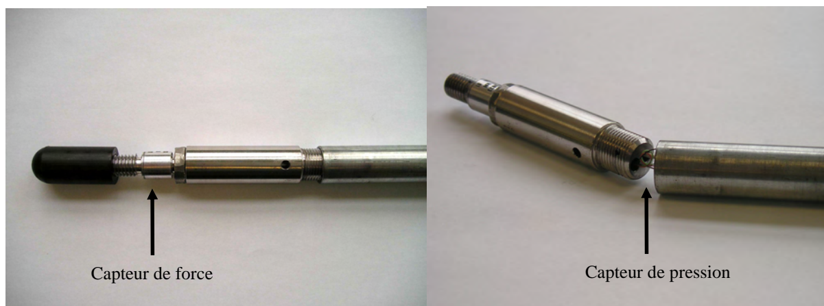
Figure 133 : Capteur de force positionné sous la tête de canne et capteur de pression.
