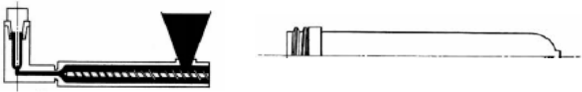
Figure 2 : Injection et stockage de la préforme [DEN-1989].
