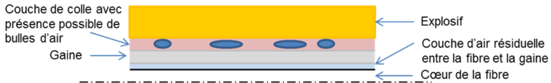
Figure 179 : Représentation schématique de l'intégration de la fibre optique à réseau de Bragg à l'intérieur du massif d'explosif
