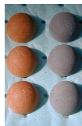
Dans l'ordre de gauche à droite : hémisphère de TNT coulé-fondu, d'un explosif composite à base de RDX, coque d'un comprimé TNT/Al et son relais à base de HMX
