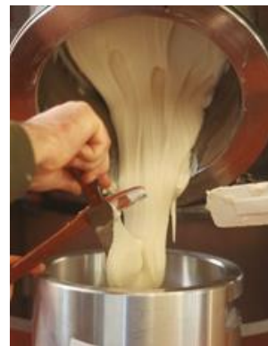
Coulée d'un explosif composite avant cuisson (photo CEA Gramat)
