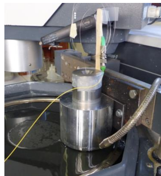
Figure 172 : Intégration de la fibre dans le bloc PMMA (à gauche) et mise en place sur la polisseuse (à droite)
