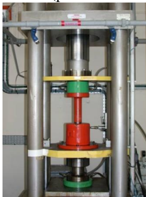
Presse uni-axiale pour la fabrication d'explosifs comprimés (photo CEA Gramat)
