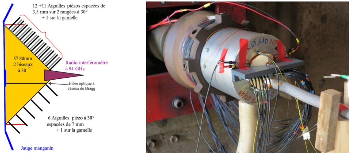
Figure 123 : Représentation schématique de la configuration améliorée (à gauche) et exemple d'implantation dans la casemate (à droite)
