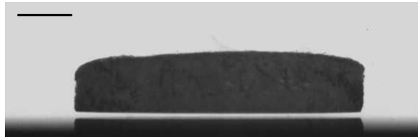
FIGURE 1.3 – Carboglace en caléfaction. L’échelle indique 3 mm.
