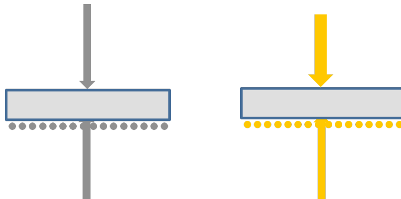
Figure III.20. Schéma de la configuration asymétrique utilisée pour l'étude des composites, avec (a) une électrode ponctuelle de Pt et une grille de Pt et (b) son équivalent en or.
