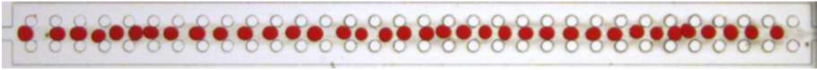
FIGURE 4.9: Dispositif expérimental de gouttes d'eau colorée s'écoulant dans de l'hexadécane + Span 80 (3 % en masse). Le pas du réseau est de 300 \mu\text{m} et le diamètre des obstacles circulaires est de 150 \mu\text{m} . La vitesse moyenne d'une particule isolée est de 1,1 \text{ mm}\cdot\text{s}^{-1} .
