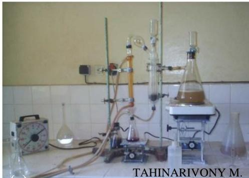
(a) Appareil à distillation
