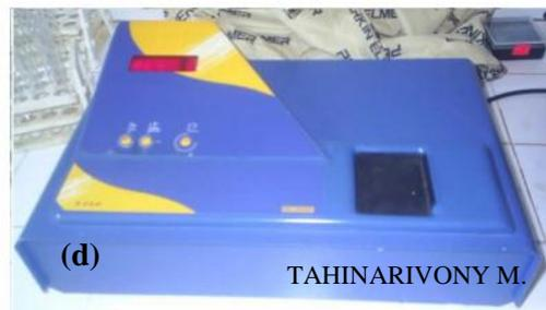
(d) Spectromètre colorimètre
