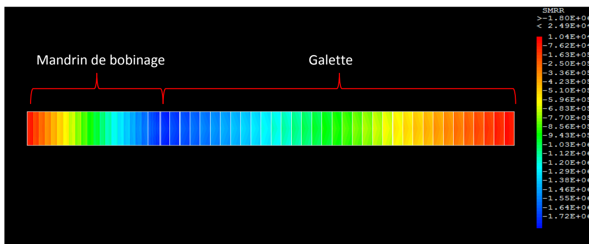
Figure IV-19 : Contrainte radiale dans une galette de 35 couches soumise à un champ magnétique B_z allant de 3,17 à 2,90 T (100 A dans le bobinage et 3 T de champ de fond) et avec une tension de bobinage de 50 N (il n'y a pas de chargement thermique), le bobinage est en compression radial et donc ne délamine plus.
