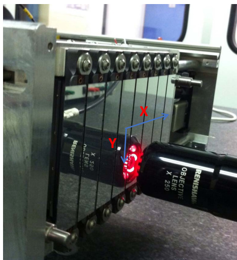
FIGURE 3.9 – Face avant du détecteur XPAD 3.2 de la ligne CRISTAL. La partie active est formée par les modules vissés sur la face avant.
