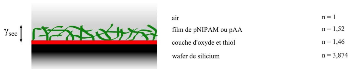
Figure 3 : Modèle à deux couches pour la détermination de l'épaisseur d'un film de polymère à l'air.
