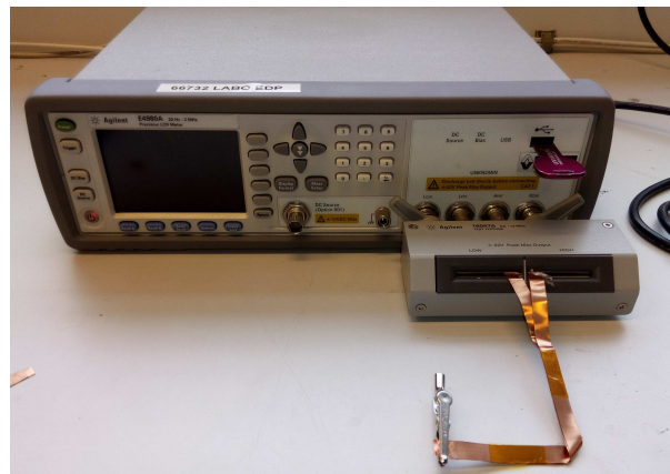
FIGURE F.7 – Mesure de l'inductance et de la résistance AC pour une longueur de raccordement
