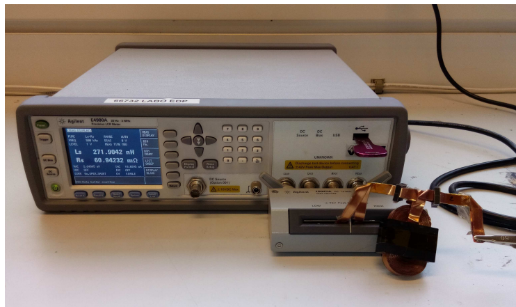
FIGURE F.6 – Mesure de l'inductance et de la résistance AC
