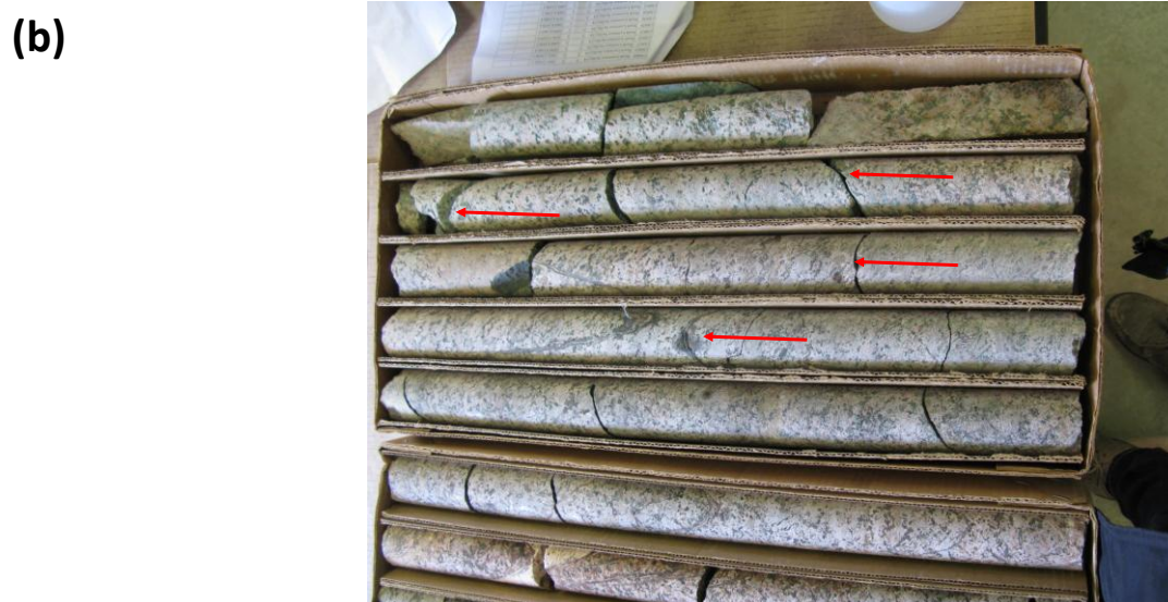
Figure 35 – (a) Photos et profondeurs associées (en mètre) des zones les plus fracturées de la carotte NP1 (en haut) et DR1-A (en bas). (b) Détail d'une zone fracturée du socle précambrien sur la carotte DR1-A à 353m de profondeur.
