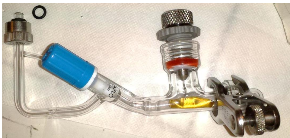
Figure 94 - Ampoule en verre comportant un perceur, le tube en or, un bouchon d'ouverture/fermeture, et une entrée sur la ligne GC.
