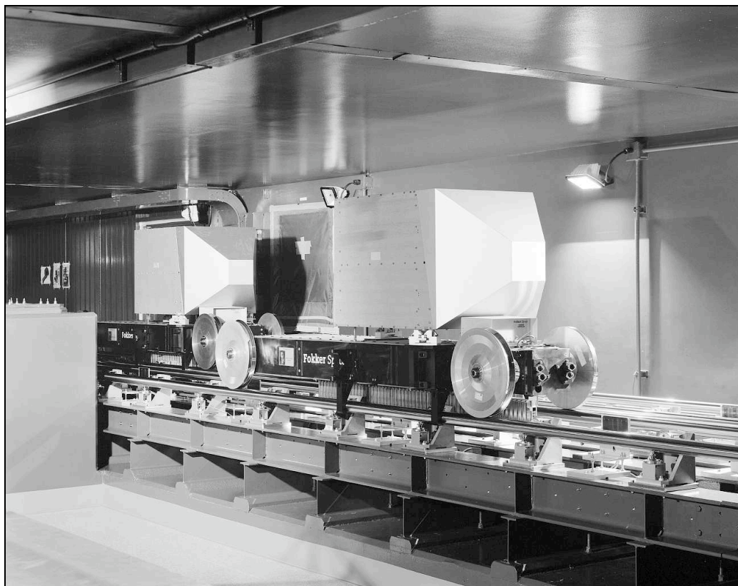
Figure 18. Les deux premières lignes à retard du VLTI (#1 et #2). A terme, huit lignes à retard permettront de recombinaison la lumière de tous les télescopes de Paranal (UT et AT).
