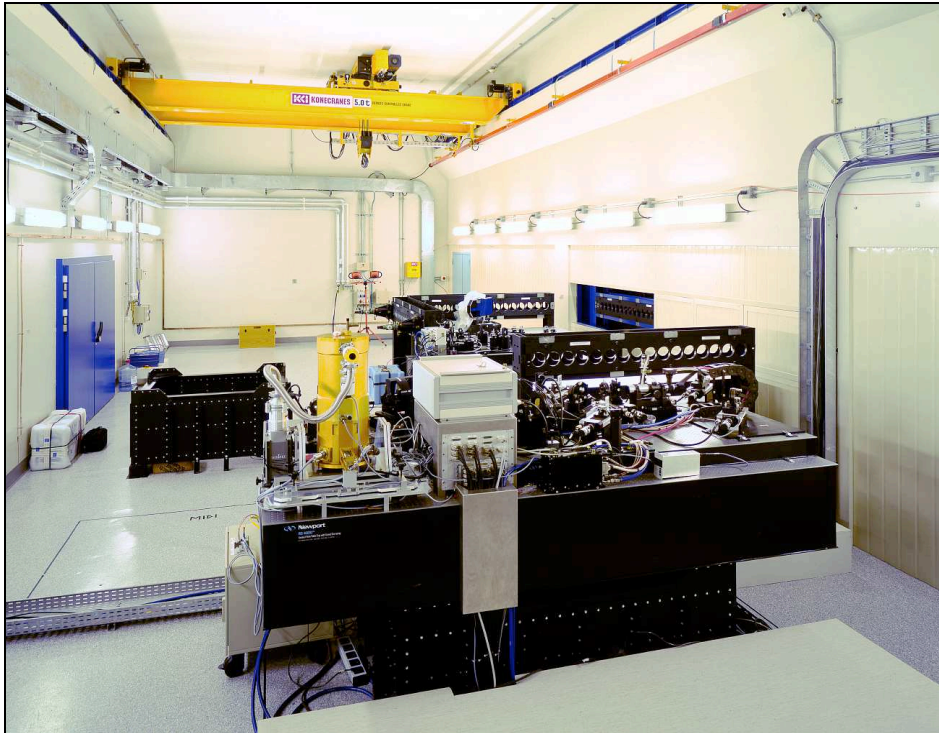
Figure 16. Le laboratoire interférométrique du VLTI, peu après les premières franges (mars 2001). La table optique de l'instrument VINCI est visible au premier plan.
