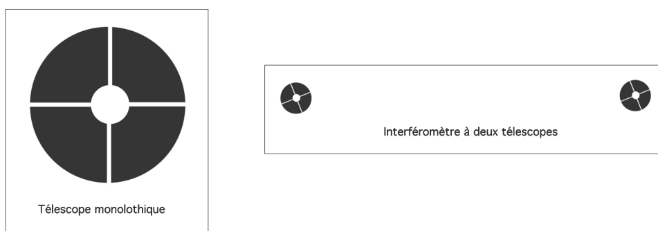
Figure 2. Pupilles comparées d'un télescope monolithique (à gauche) et d'un interféromètre à deux télescopes (à droite).
