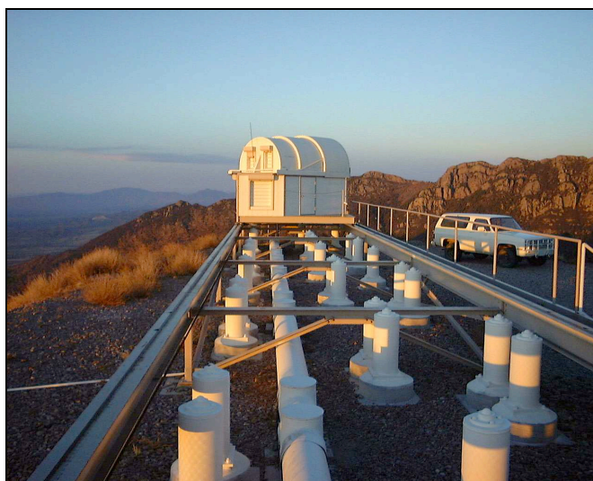
Figure 12. Vue sur le bras nord de l'interféromètre IOTA. Le sidérostas (dans l'abri au centre) se déplace sur les rails visibles sur les côtés, et vient se positionner sur les colonnes du premier plan. Ceci permet d'obtenir une longueur de base variable (jusqu'à 38 mètres).
