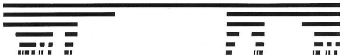
Figure 19. Construction de l'ensemble de Cantor (a) régulier, (b) aléatoire (Mandelbrot, 1975).
