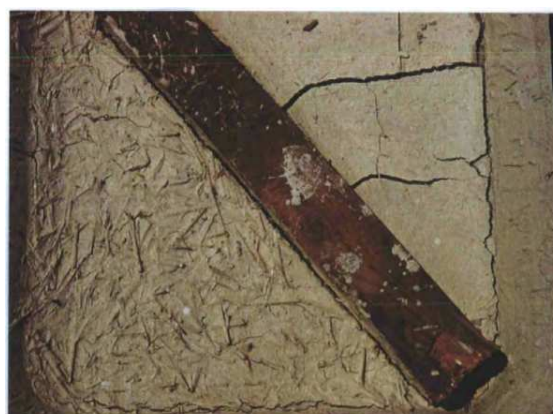
(b) Etat sec de la bauge avec et sans fibre
