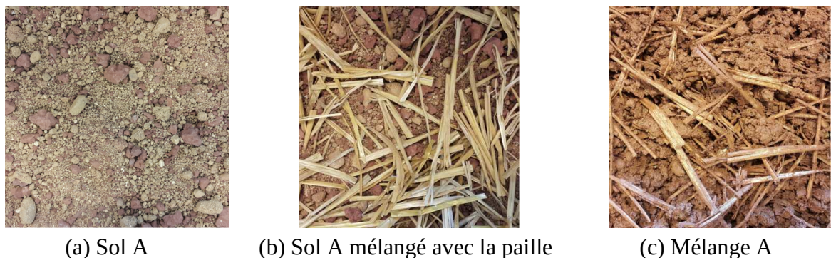
Figure II-14 : Etapes de préparation d'un mélange terre-fibre.
