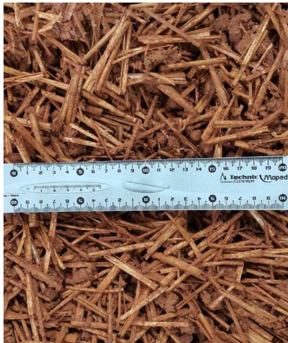
Figure IV-21 : Mélange terre-paille à l'état humide
