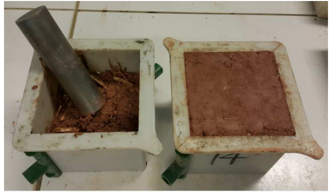
(b) Compacter et surfacer les échantillons
