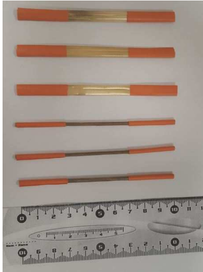
(a) Fibres utilisés pour l'essai de traction
