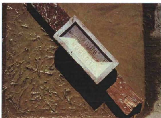
(a) Etat frais de la bauge avec et sans fibre
