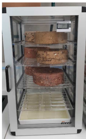
Figure II-28 : Dessiccateur avec solution saline saturée
