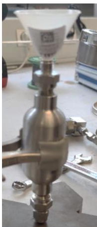
Figure III-4 : Remplissage du réservoir avec le C_5F_{12} liquide à température ambiante
