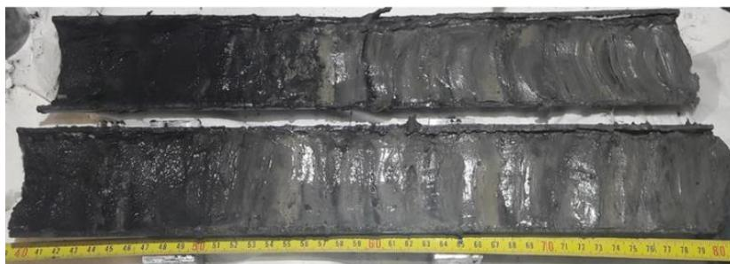
Figure III-13. Photographie d'un tronçon de la carotte de sédiments TIG19\_2 après sa découpe en BAG. Un échantillonnage est effectué selon les faciès identifiés à l'œil à l'échelle centimétrique.
