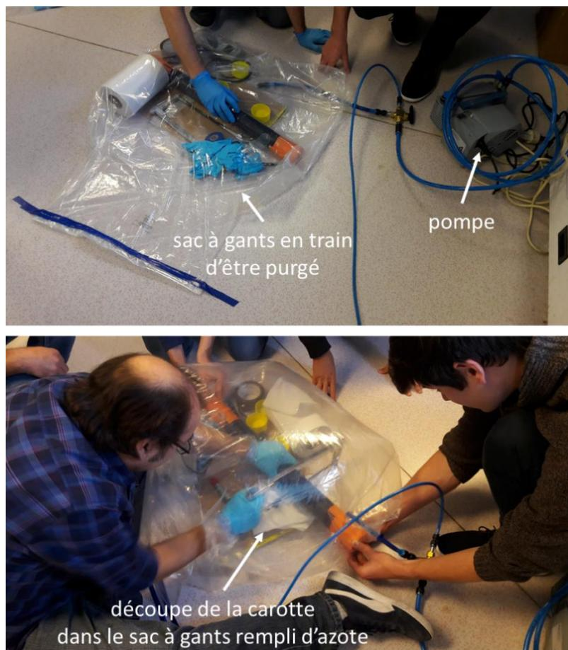
Figure III-12. Photographies des étapes de découpe de carotte de sédiments TIG19\_2. En haut, les éléments nécessaires à la découpe de la carotte ont été insérés dans le sac à gants et ce dernier est purgé à l'aide d'une pompe pour en extraire l'oxygène et rempli à l'aide d'azote. En bas, le tronçon de carotte est en train d'être découpé en atmosphère anoxique dans le sac à gants avant d'être inséré en boîte à gants.
