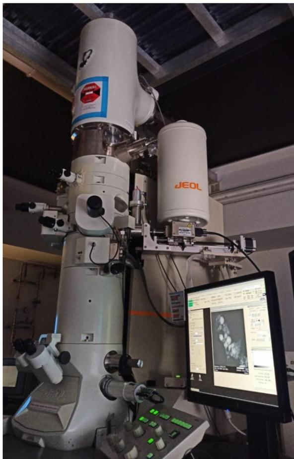
Figure III-19. Microscope Electronique à Transmission JEOL 2100F de la plateforme de l'IMPMC.
