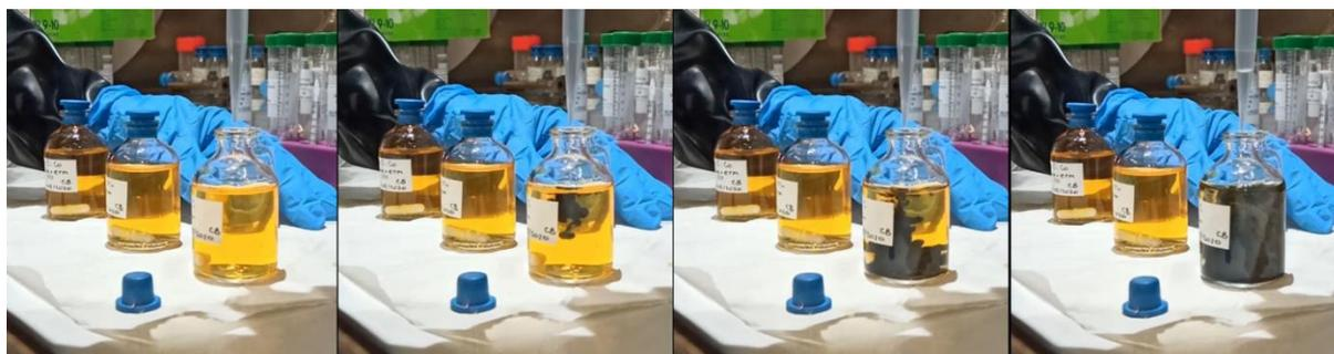
Figure III-2. Séquence d'images présentant le démarrage d'une synthèse de pyrite correspondant à l'ajout d'une solution de  $\text{Na}_2\text{S}\cdot 9\text{H}_2\text{O}$  dans une solution de  $\text{FeCl}_3\cdot 7\text{H}_2\text{O} + \text{ETM}$  en boîte à gants.
