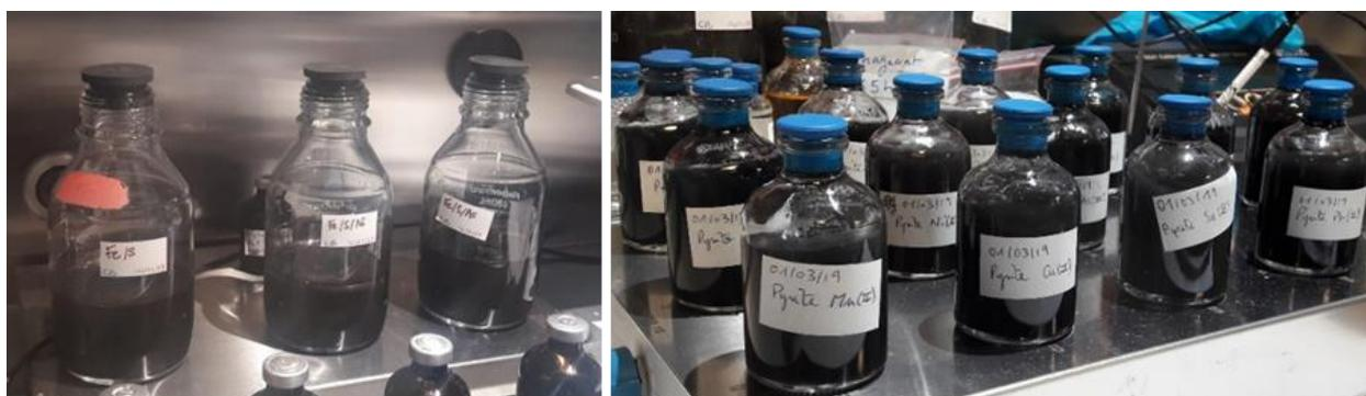
Figure III-3. Exemple de flacons contenant les différentes synthèses de pyrite en boîte à gants.
