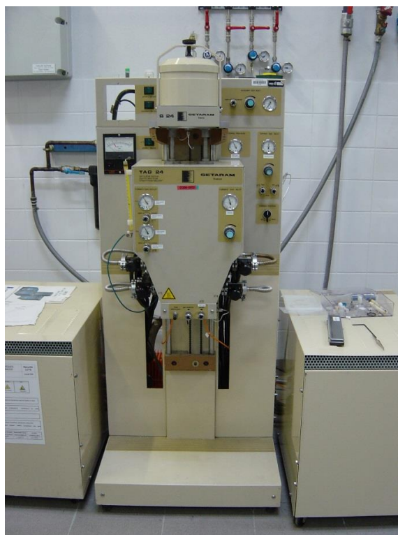
Figure 2.24 - (a) dispositif utilisé pour les mesures ATG, (b) dispositif utilisé pour les mesures DSC.
