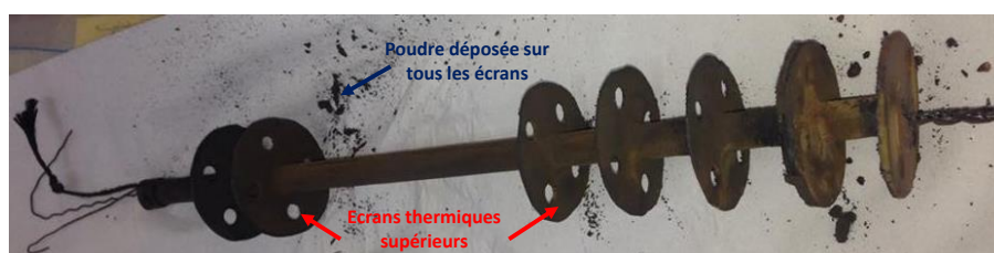
Figure 4.1 - Etat des écrans thermiques après le traitement CVD avec le système DCMS/H 2 .
