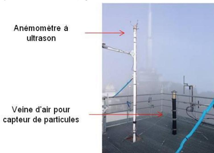
**Figure 139 : Veine d'air pour les capteurs aérologiques et anémomètre à ultrasons installés sur la plate-forme d'instrumentation**
