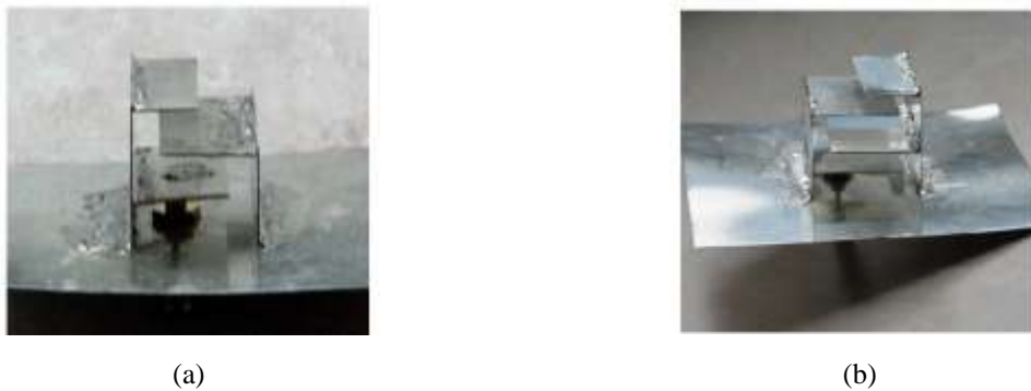
Figure I. 15: Prototype de l'antenne repliée pour adresser: la bande 1575 MHz (a) la bande 896 MHz (b) [26].
