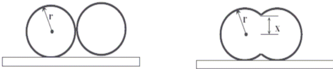
Figure 66: Evolution de l'interface au cours de la coalescence des deux grains de polymères.
