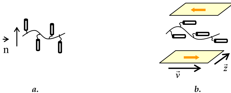
Figure 1.16. : a. Conformation oblate de la chaîne principale de polymère à l'équilibre ; b. Conformation prolate de la chaîne de polymère dans la phase nématique induite sous cisaillement dans la phase isotrope ; \vec{n} est le directeur, \vec{v} est la vitesse et \vec{z} l'axe neutre.
