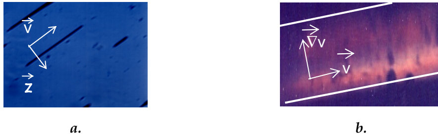
Figure 1.15.: A T > T_{NI} et \dot{\gamma} > \dot{\gamma}^* : phase isotrope du PCLP de la réf. [48] sous cisaillement : a. Apparition d'une forte biréfringence (plan (vitesse, axe neutre), polariseurs croisés formant un angle de 45^\circ avec la vitesse) ( \lambda=4700 \text{ \AA} ), b. Photographie de la répartition de la biréfringence obtenue entre polariseurs croisés dans le plan (vitesse, gradient de vitesse) pour le polymère de la réf. [55]. Les bords de la cellule de cisaillement sont visualisés en blanc
