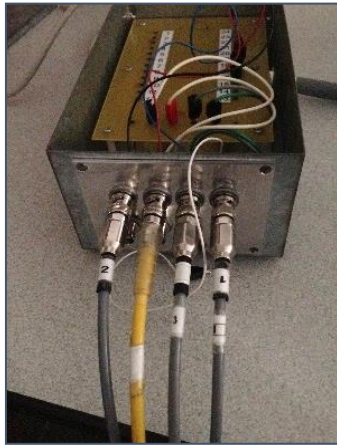
Figure 2-17 : (a) Photo du cryostat à l'IMEP-LaHC (b) Photo de la matrice pour l'adressage des différents OTFTs du module (c) Photo d'un module avec 4 transistors ayant des contacts déportés par wirebonding.
