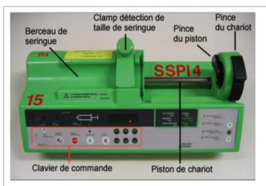
Figure 9 - Eléments composant un pousse-seringue
