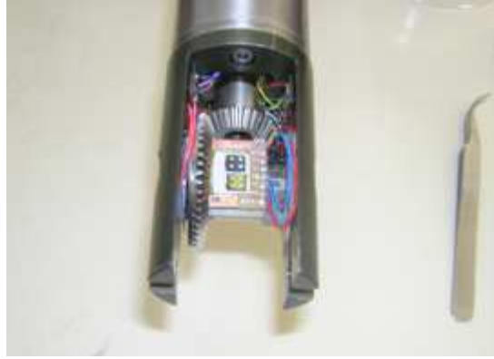
Fig. 2.24. Canne du cryostat et porte-échantillon.
