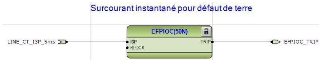
Figure 46 : Protection instantanée de défaut de terre
