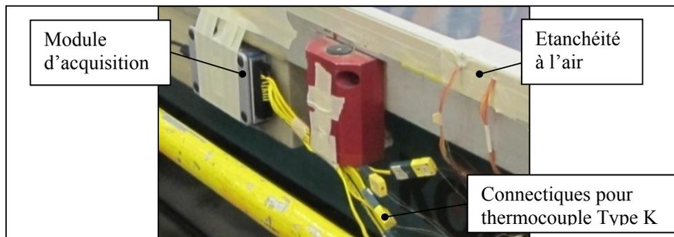
**Figure 2.7** Connexion des thermocouples avec le module d'acquisition
