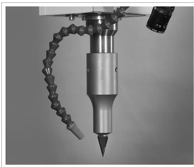
Figure 2.7 Tête de découpe ultrasonique RC590
