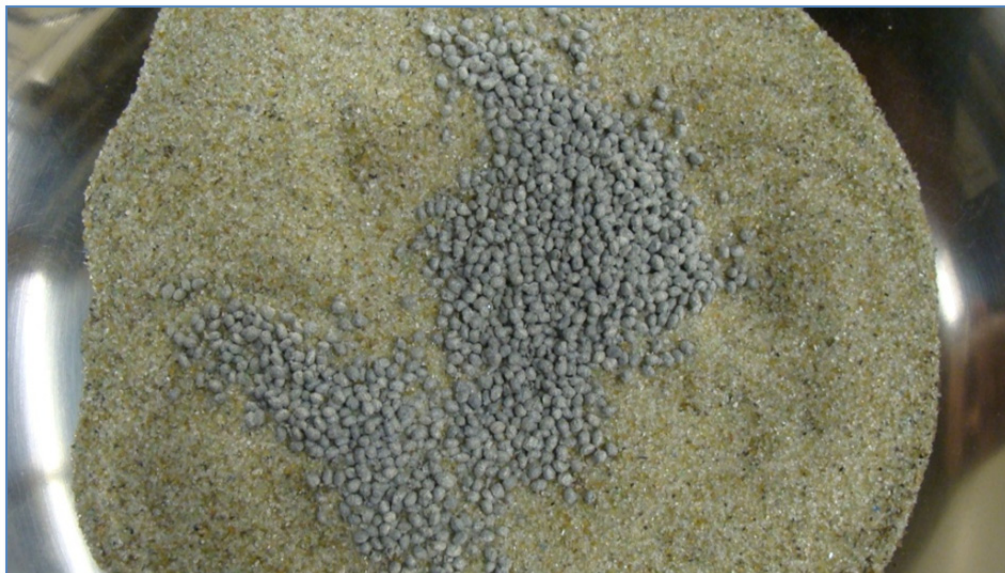
Figure 3.4 Granules de SBS avant malaxage à chaud dans le sable de verre C
