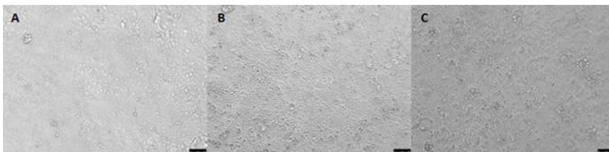
Figure 40 Test de biocompatibilité sur les composants du Cellware Hepia (A) Croissance cellulaire sur la colle EPO-TEK® de chez EPOXY TECHNOLOGY après 4 jours ; (B) Croissance cellulaire sur le scotch 3M 467MP 200MP Adhesive après 4 jours ; (C) Croissance cellulaire contrôle après 4 jours ; Ensemencement 114'300 cellules/cm<sup>2</sup> ; Echelle 75 µm
