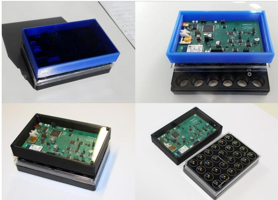
Figure 69 Impédancemètre complet sans fluide : Cellware Hepia et Hardware Hepia
