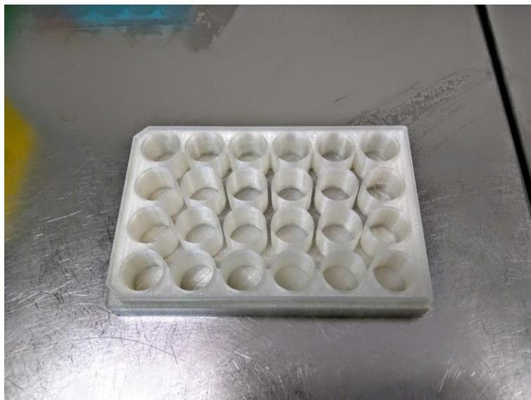
Figure 66 Plaque de culture 24 puits imprimée en acide polylactique (PLA) avec l'imprimante 3D Ultimaker 2
