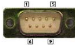
DB9 male (utilisé pour un DTE)
