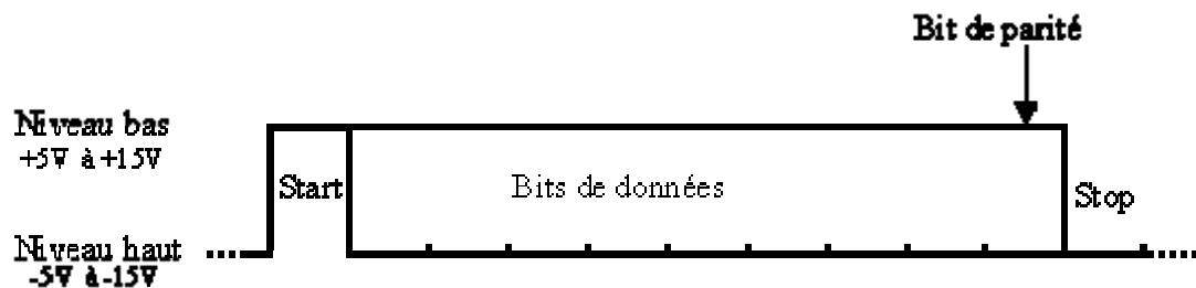
Figure 2.9: Une trame de donnée pour une transmission série asynchrone
