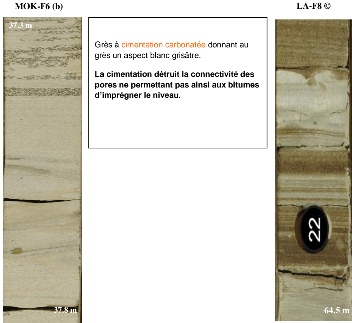
Photo 5: Carottes de grès à niveau blanchâtre cimenté par des éléments carbonatés
