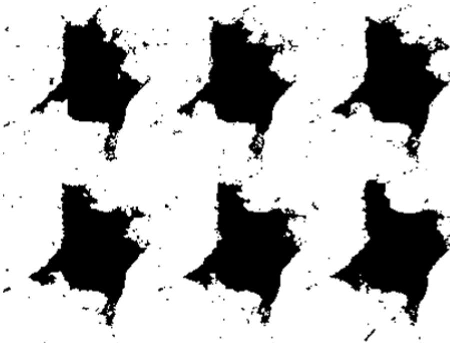
FIGURE 4.2: Coupes 2D (de 48 à 53) d'une image tomographique 3D de sol p1bkk03a. On extrait d'abord les voxels décrivant l'espace poral par seuillage grâce à l'estimation de la valeur de porosité. Les pixel des pores sont en noir et les pixels de la partie solide sont en blanc.
