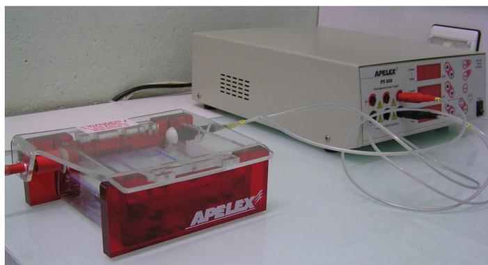
**Figure 7: Cuve à électrophorèse horizontale (mini gel APELEX 311.000) et générateur (APELEX PS608)**
