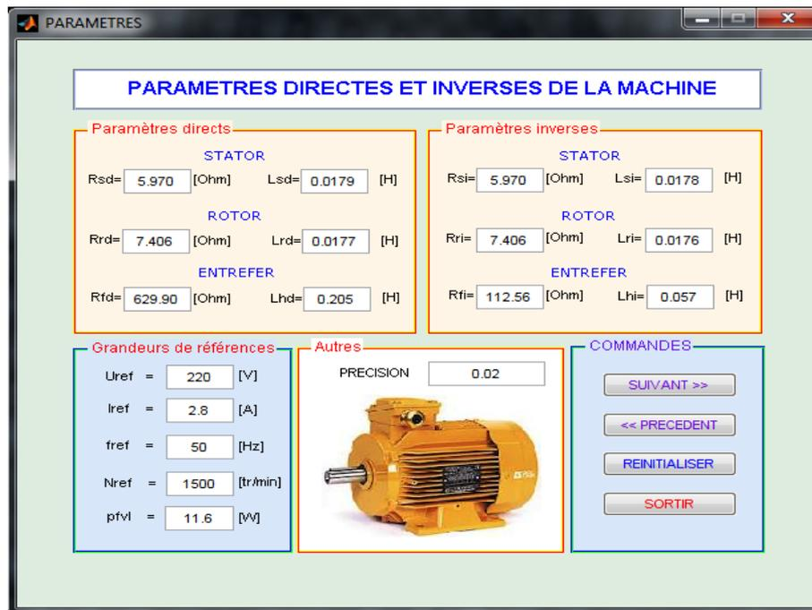
Figure 20 : Introduction des paramètres
