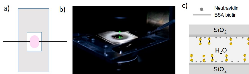
Figure 4.1 – a) Vue de dessus d'une chambre microfluidique. La partie grise représente la couche de paraffine, le liquide est indiqué en rose et les traits noirs correspondent aux embouts de pipette. b) Photographie d'une chambre microfluidique montée sur le microscope. c) Représentation en coupe d'une chambre microfluidique fonctionnalisée.
