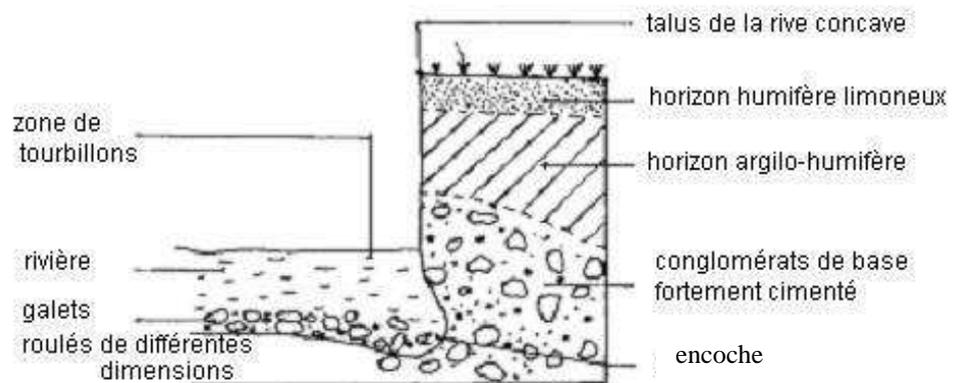
**Figure N°12: Profil montrant les conglomérats de base au niveau d'un méandre sur la rivière Ankeniheny**
