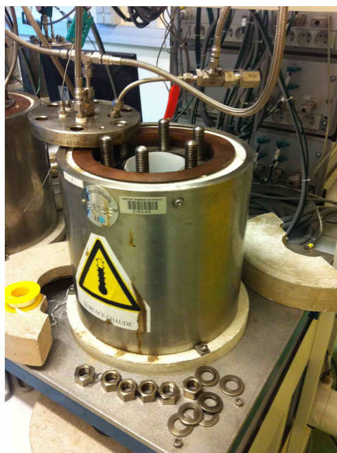
Fig 1.9. Détails du dispositif expérimental de la chambre de vieillissement chauffante et pressurisée.
