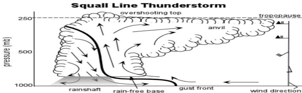
Figure 14 : Coupe verticale d'une ligne de grains. [22]
