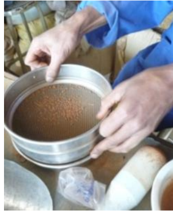
Photo 4 : Tamisage à 2\text{mm} et broyage à 0,2\text{mm} des échantillons de sol
