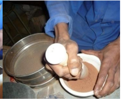
Photo 4 : Tamisage à 2\text{mm} et broyage à 0,2\text{mm} des échantillons de sol
