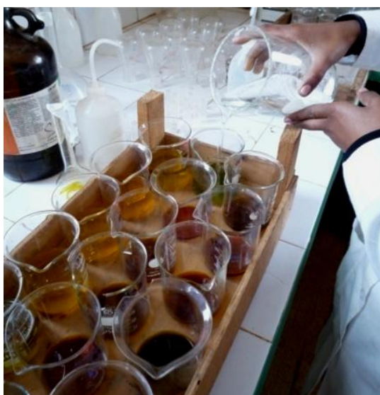
Photo 5: Echantillons de sol dilués avec de l'eau distillée
