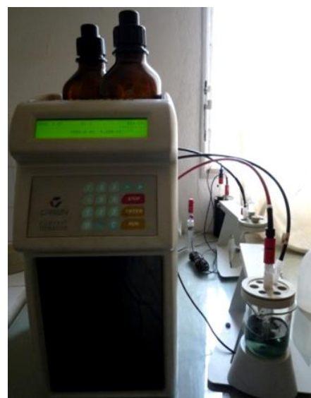
Photo 6: Titrateur Crison pour titrer l'excès de dichromate
