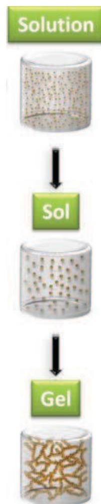
Figure 1 : Principe simplifié du procédé sol-gel
