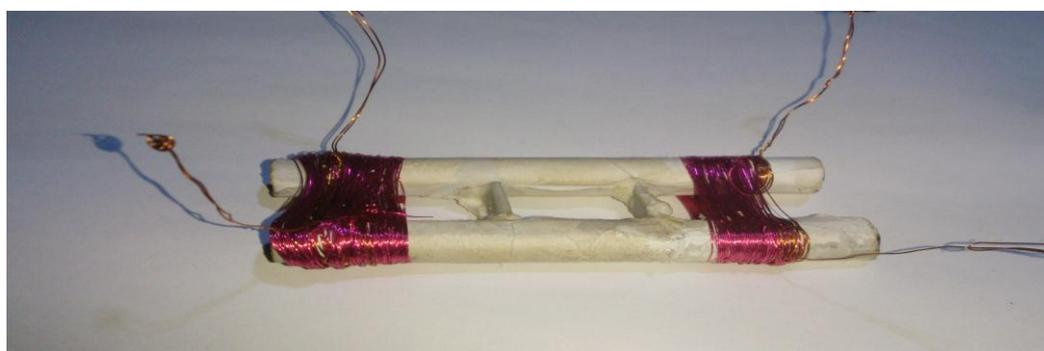
**Figure 4.2** : Enroulements des bobines d'excitation et de mesure.
