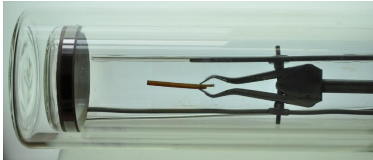
Figure 8. Un bilame est placé en porte à faux (single cantilever) maintenu par une pince au sein d'un enceinte à atmosphère inerte à température contrôlée. Vue de côté du montage. a) expérience MS : le vitrimère « mou » est au-dessus ; b) expérience MI, le vitrimère « mou » est en-dessous.
