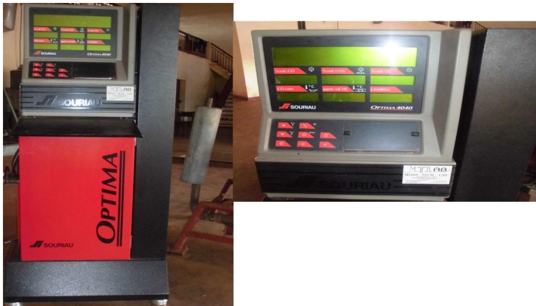
Figure 30: L'analyseur de gaz SOURIAU 4040 [source : auteur]
