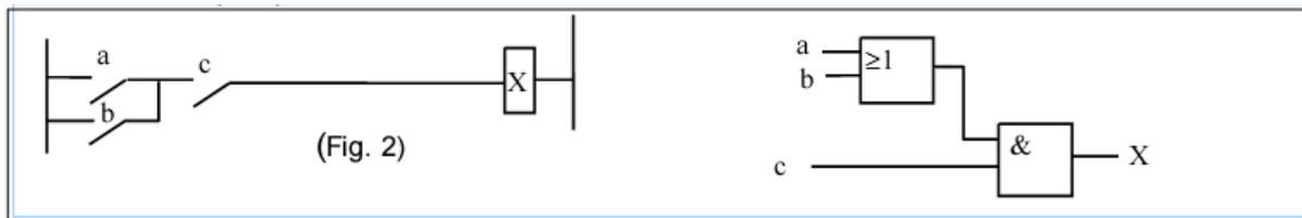
Figure 2.6 : Schéma câblé de  $X = (a+b).c$
