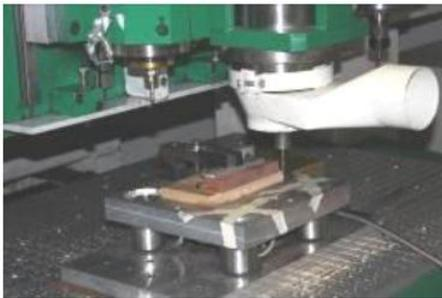
*Figure 5: Usinage des éprouvettes avec la machine à commande numérique DUBUS (Cliché: Ramanakoto, 2014)*
