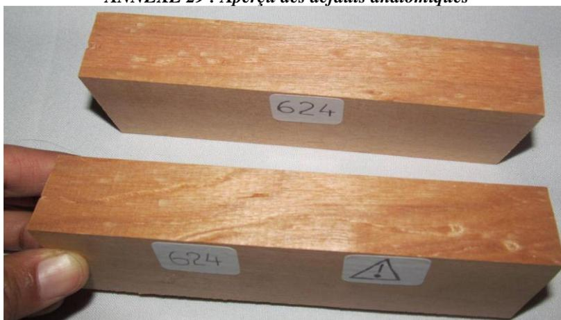
Figure 45 . Démonstration de la différence entre deux éprouvettes usinées suivant les mêmes paramètres d'usinage, mais dont l'un des états de surface présente des défauts anatomiques (en bas)
