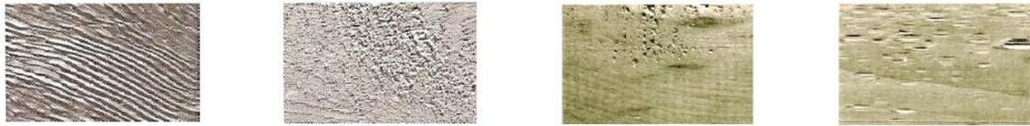
*Fibres soulevées**Fibres pelucheuses**Fibres arrachées**Marques de copeaux***Figure 13 : Défauts principaux de la surface selon la norme ASTM- D1666-87 (Source : Khazaein, 2006)**
