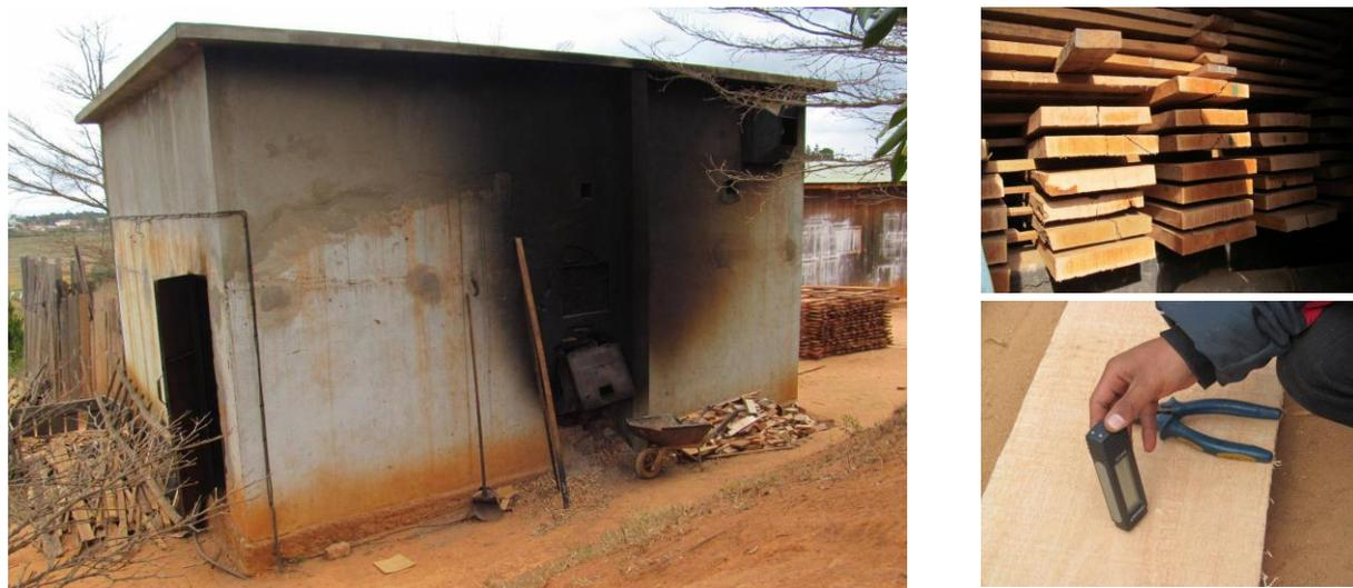
Figure 37 : Séchoir au niveau du MESA (à gauche) ; les planches de Famelona empilés dans le sechoir (à droite en haut) et mesure de l'humidité du bois avec l'humidimètre (à droite, en bas) (clichés : auteur, 2013)
