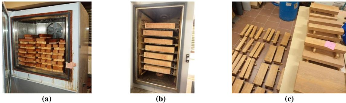
*Figure 3 : Séchage des bois de Famelona (a) et (b) dans l'enceinte climatique (pour les éprouvettes de grandes dimensions qui séchent difficilement) ; (c) à l'air libre (pour les éprouvettes de petites dimensions) (Clichés : Ramanakoto, 2014)*
