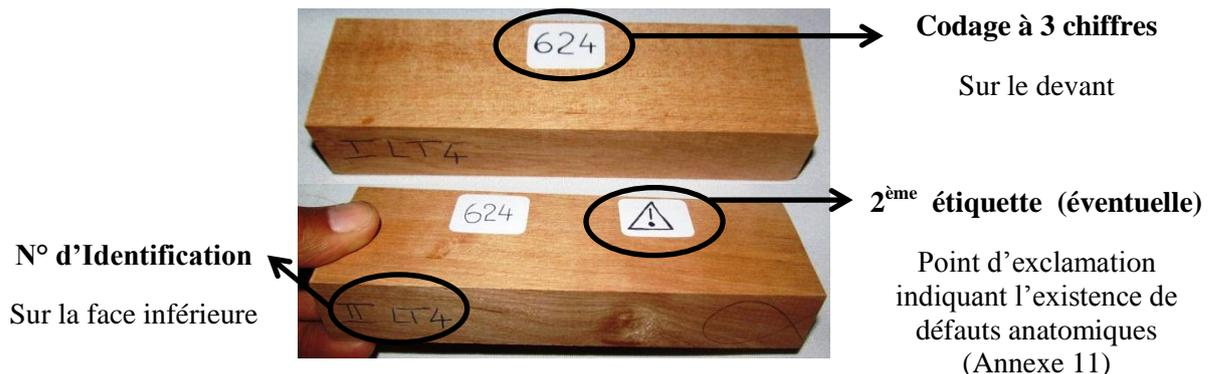
**Figure 16 . Numéro d'identification (en bas des éprouvettes) et codage à 3 chiffres (sur les étiquettes en blanc) attribués à chaque éprouvette. (Clichés : Auteur, 2014)**
