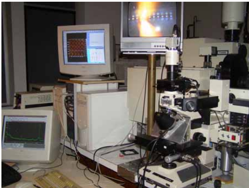
Figure I-2 - Composants de base d'un spectromètre Raman. Bien qu'initialement la géométrie dite à 90^\circ ait été employée, la plupart des systèmes modernes utilisent une géométrie en rétrodiffusion ( 180^\circ ), telle que décrite sur cette figure.
