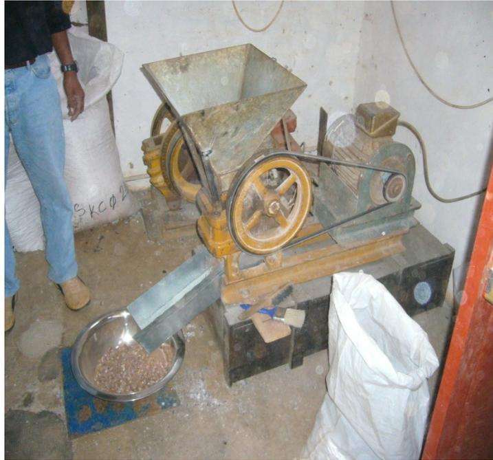
Photo N° 12. Broyeur à mâchoire de la BRGM
