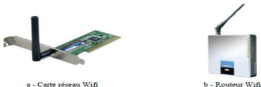
**Figure 20 : Exemples de produits mettant en œuvre des monopoles**
