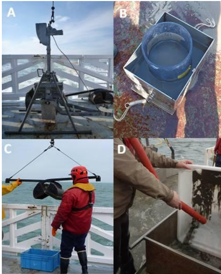
Figure II.5. Photographies des engins de prélèvements (A : carottier Reineck ; C : benne Van Veen), (B) sous échantillonnage d'une carotte de sédiment issue d'un prélèvement au carottier Reineck, (D) tamisage du sédiment issu d'un prélèvement effectué à la benne Van Veen.
