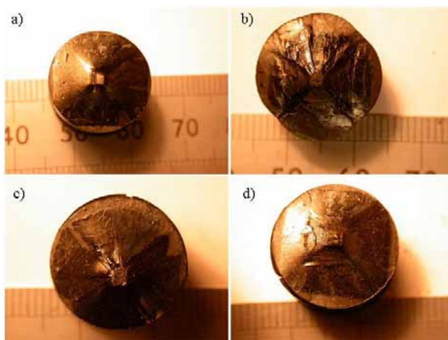
Figure 77 : Disques de Y123 obtenus par infiltration croissance, à partir de a) Y211 commerciale, b) Y211 broyée, c) Y211 + 0.5% en poids Pt et d) Y211 broyée + 0.5% en poids de Pt.
