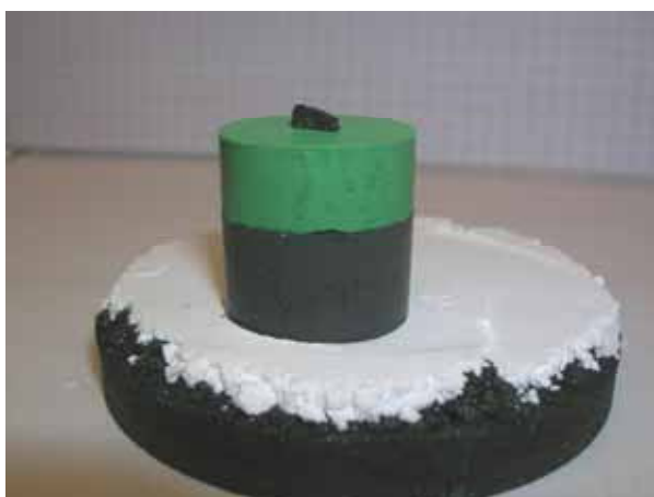
Figure 43 : Photographie d'un échantillon avant le traitement thermique d'infiltration et croissance (montage « - »).
